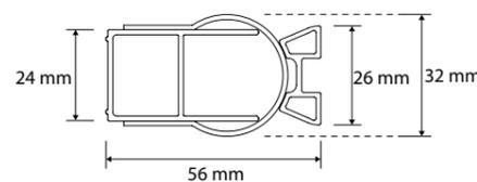
El conjunto de perfiles tiene una medida de 66 mm. El ancho del perfil a pared es de 24 mm, mientras que el perfil que marca los grados tiene un ancho de 26 mm. El diámetro del perfil circular es de 32 mm.
